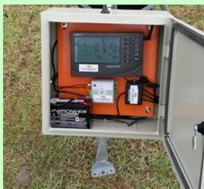
Ilustração 01 – painel para instalação do controlador e string box
